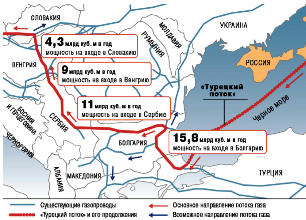
Рисунок 7 Возможный маршрут сухопутного продолжения второй нитки «Турецкого потока»
